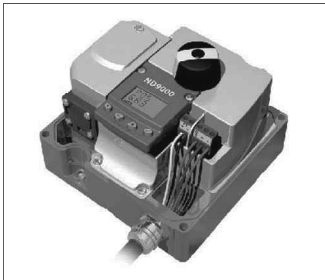
图 1 就地用户接口使用户能在显示窗内了解实时的控制参数
